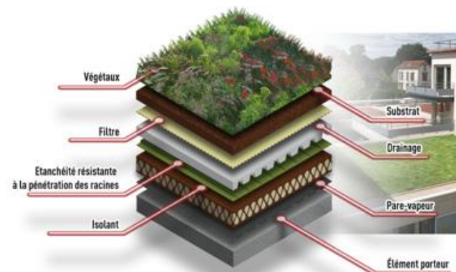
Coupe technique toiture végétale ©ALTERNATIVE ∪ AUTONOMIE
